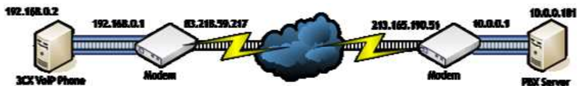
Abbildung 4 – Funktionsweise eines Tunnels
